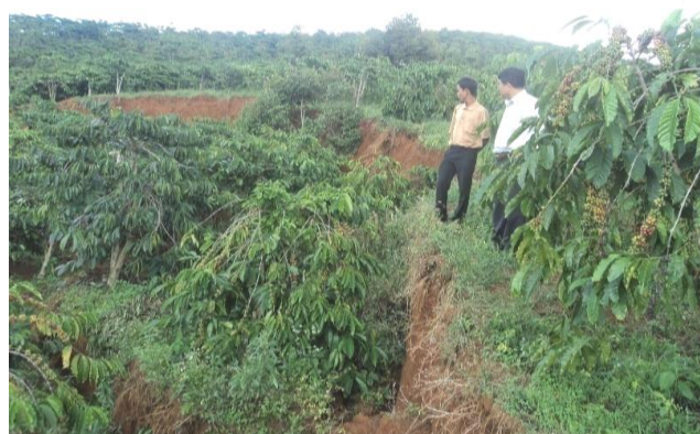
Hình 2. Đỉnh khối trượt tại vị trí sạt trượt số 4 - ảnh chụp ngày 19/9/2013
